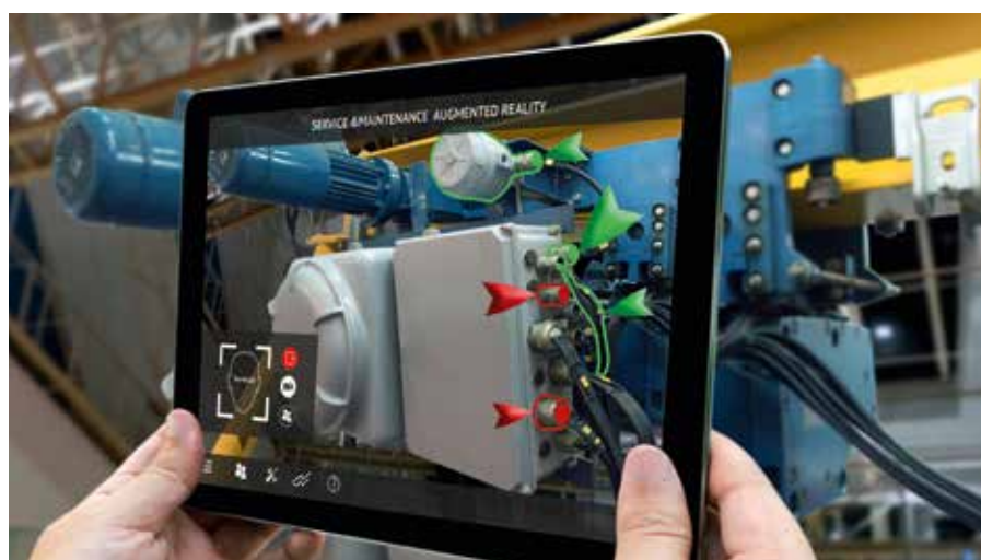
Système d'assistance à la localisation de défauts sur un entraînement de machine
