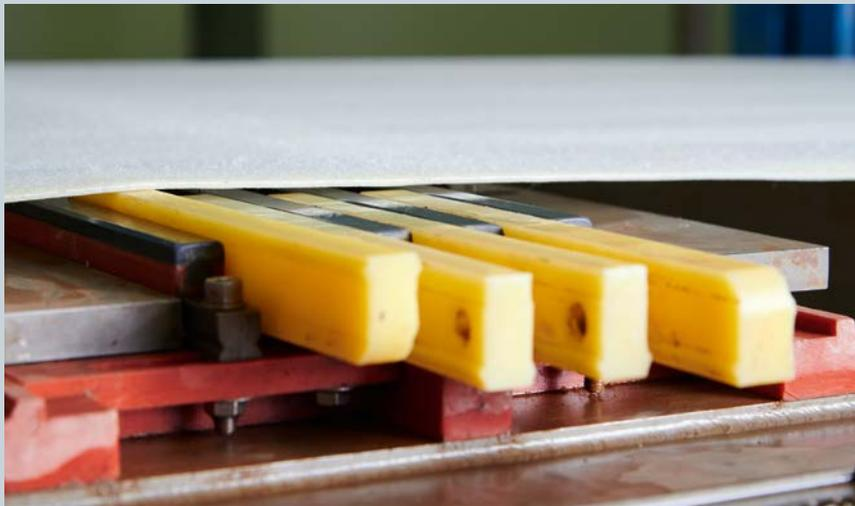
Fig. 11 : Limiteur de bord surélevé sur la caisse de feutre
