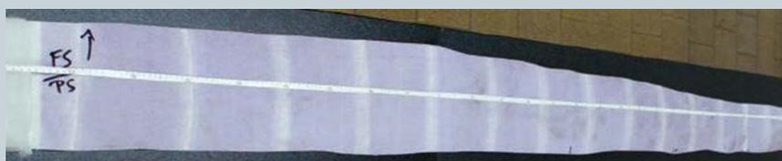
Fig. 8 : Bandes d'usure visibles dans ce feutre descendu
