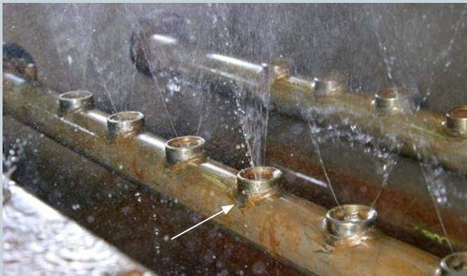
Fig. 4 : Application d'eau inégale en raison de jets turbulents
