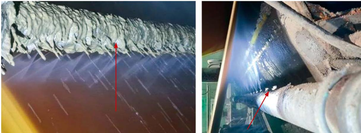
Fig. 4 : Rinceurs présentant des dépôts de saleté et des buses partiellement obstruées
