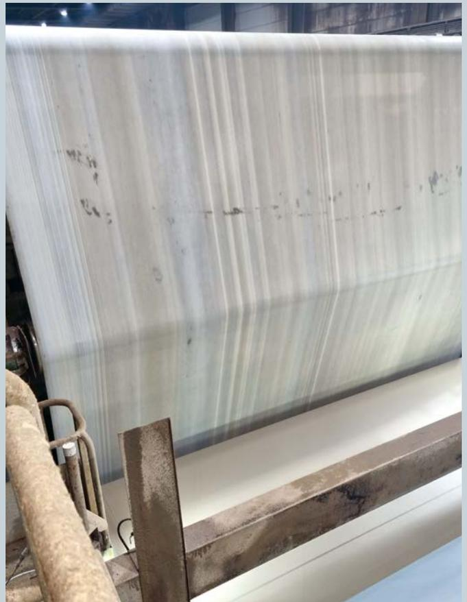
Fig. 6 : Résultat : des bandes humides dans le feutre
