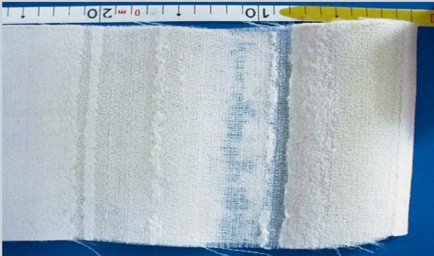
Fig. 10 : Perte complète des fibres du voilage dans la zone du bord du feutre
