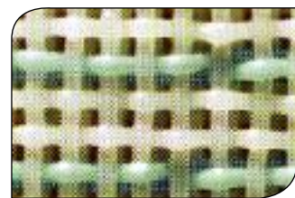
Maschenlänge in Laufrichtung < 0,22 mm
