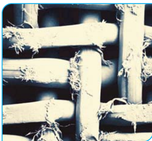
Abb.10 Siebschädigung durch zu hohe Strahl-Energie
