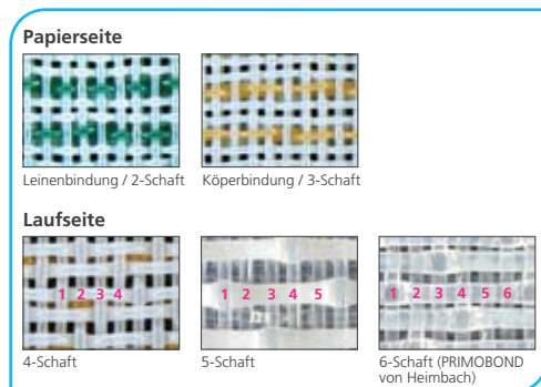
Abb. 11 Mögliche Bindungen bei Papier- und Laufseite
