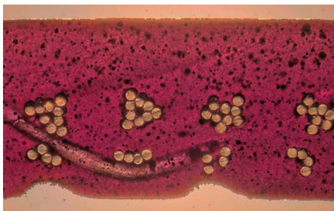
Foto 1: Webmover im vergrößerten Querschnitt.
